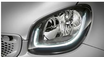
Fari alogeni H4 con funzione Welcome e luci diurne a fotoconduttori LED integrate
