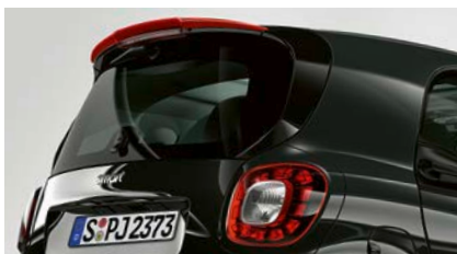
Spoiler sopra lunotto BRABUS con mano di fondo e terza luce di stop BRABUS color fumé
