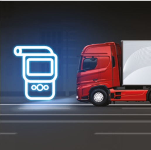
PREDISPOSIZIONE ALCOL INTERLOCK Il motore non può essere avviato se il conducente non supera il test alcolemico, garantendo così la sicurezza alla guida come prerequisito fondamentale.
